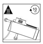
3) Deje calentar la herramienta durante 10 minutos. El tiempo de calentamiento puede variar según la temperatura ambiental, humedad del material, entre otros factores. Realice pruebas sobre el material hasta que se genere la intensidad de marca deseada.
