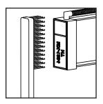
5) Limpie la superficie de marcaje según sea necesario. La herramienta puede acumular material calcinado en el área de contacto, por lo que se recomienda que se limpie con un cepillo de latón.
