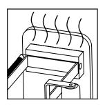
4) Comience el marcado. Esta herramienta es de alta potencia y esta diseñada para marcar constantemente. Apague el equipo en caso de que no se realicen marcajes por más de 5 minutos.
